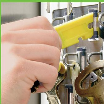
Ключи крепятся на интеллектуальные брелки, имеющие встроенный чип с уникальным идентификатором и трехмиллиметровой дужкой из нержавеющей стали. Данные со встроенного чипа используются для проверки авторизации каждый раз, когда необходимо извлечь ключ из хранилища или вернуть его на место. Доступ к ключу возможен только авторизованным пользователям, права которым назначаются индивидуально.
